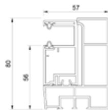
Guida (PVC) singola - RS revisione dall'esterno. MK933 + MK9760
